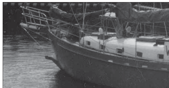
Zo ziet de boeg van de WILLIWAW er uit. De vreemde uitbouw is gemaakt om de ankerketting(en) te geleiden. Door de ketting via de rollen in de uitbouw te geleiden kan het schip ten anker liggend vrij rondzwaaien zonder de verstaging van de boegspriet te beschadigen.
